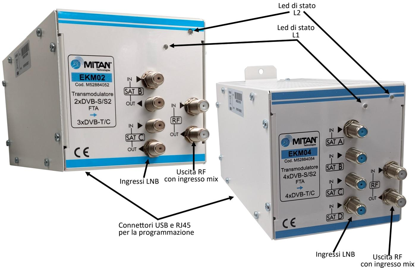
LED di stato L1 - ricezione satellite: 1 lampeggio per tuner (2 per EKM02 e 4 per EKM04), verde per i tuner che hanno agganciato il segnale e rosso per quelli che non sono sintonizzati.
